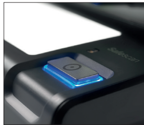
Automatische Standby Funktion mit Sensor zum erneuten Einschalten
